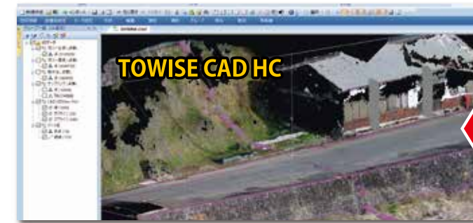
TOWISE CAD HC 画面に表示された横断方向線。点群やTINの高さを現況縦断、現況横断データの測点、変化点に採用することができます
