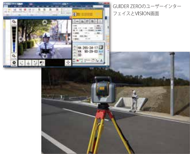
ロボティック機能と GUIDER ZERO を組合わせた効率的な地形測量
