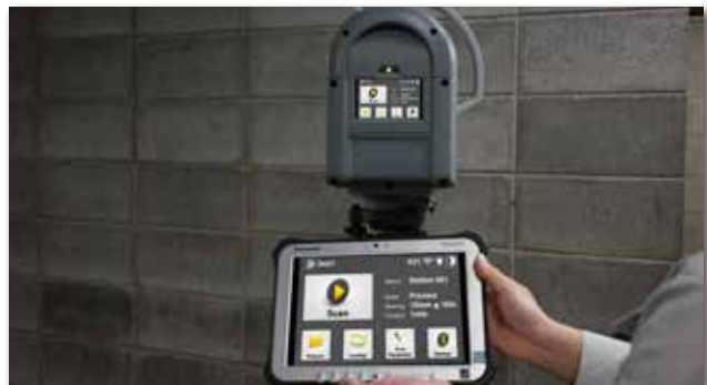
Wi-Fi 通信により、タッチパネルと同様の操作が可能
