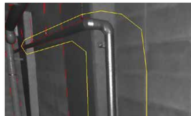
3D レーザースキャナーが取得する点群は膨大な量となります。全ての点群を表示すると環境によってはコンピュータのパフォーマンスを低下させることもしばしば。Trimble RealWorks の ScanExplorer は、指示したエリアに対して限定的に設定した点群密度で点群を抽出することが可能です。快適な表示パフォーマンスを保持しながら、必要な範囲の点群のみを抽出、さらに快適な編集が可能なこの機能を持つ Trimble RealWorks は高い生産性を提供します。
