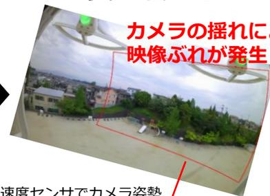
角速度・加速度センサでカメラ姿勢を検出し、カメラ姿勢変化をキャンセルするように、画像切出し位置を変えて歪補正
