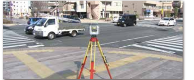
同一エリアを複数回に分けてスキャン。交通車両が多い国道や交差点の路面スキャンにおいてもデータ欠損が生じにくいスキャン方式。通行する車両や人などのノイズはオフィスソフトウェアで簡単かつ確実にサンプリング可能。 (Trimble RealWorks / Trimble Business Center)
