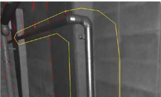
3D レーザスキャナが取得する点群は膨大な量となります。全ての点群を表示すると環境によってはコンピュータのパフォーマンスを低下させることもしばしば。Trimble RealWorks の ScanExplorer は、指示したエリアに対して限定的に設定した点群密度で点群を抽出することが可能です。快適な表示パフォーマンスを保持しながら、必要な範囲の点群のみを抽出、さらに快適な編集が可能なこの機能を持つ Trimble RealWorks は高い生産性を提供します。
