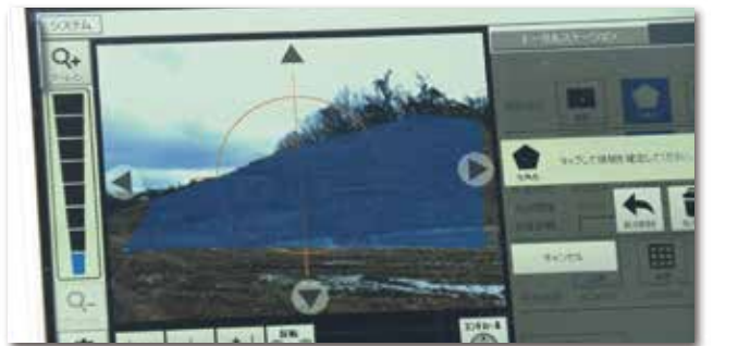
画面上に映し出される映像を見ながら自由自在にスキャンエリアを指定可能。データ容量とスキャン時間の大幅削減が可能。
