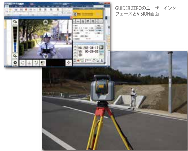
ロボティック機能と GUIDER ZERO を組み合わせた効率的な地形測量
