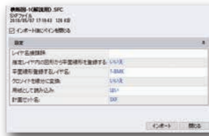
SXFファイルインポート時の設定レイヤ名を指定しながら線形クロソイドデータの登録を行う
