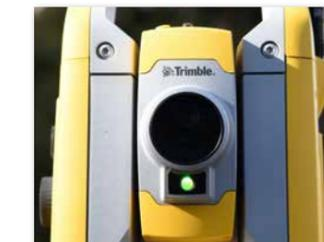
Trimble S5シリーズには視準レンズの下にトラックライトが搭載されています。器械に向かって立つ位置により見える色が変化します。
