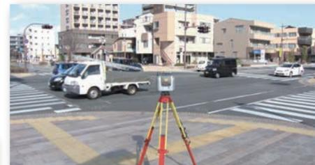
同一エリアを複数回に分けてスキャンします。交通車両が多い国道や交差点の路面スキャンにおいてもデータ欠損が生じにくいスキャン方式です。通行する車両や人などのノイズはオフィスソフトウェアで簡単かつ確実にサンプリング可能です。（Trimble RealWorks / Trimble Business Center）
