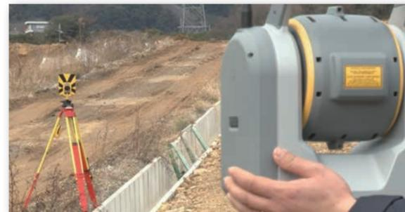
測角精度1"、測距性能1mmのトータルステーションとしての高い精度に加えて、サーボ駆動+オートロックを利用した自動対回観測は、秀逸な機能です。高精度かつ高生産性を提供する自動対回観測機能は、GUIDER 3D（Trimble SX10観測ソフトウェア）に標準で搭載されています。
